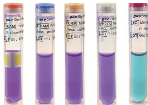
Instant-Mini-Bio-Plus SCBI para vapor, estándar SCBI para procesos de esterilización con vapor, formaldehído, peróxido de hidrógeno y óxido de etileno.
